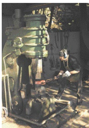
Dimensionado del acero en el martinete
